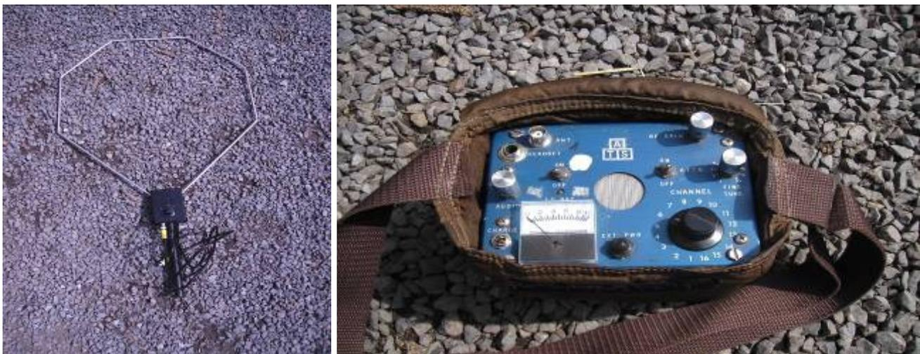
**Figure 16 et 17** : appareil de réception constitué de l'antenne et du récepteur (ATS).
